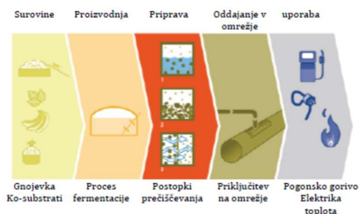
Slika 2: Sistem prečiščevanja bioplina za oddajo biometana v omrežje (Informationsstelle Biomassenergie, 2014).
